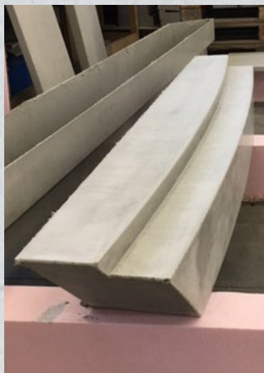
Fenstereinfassung mit großem Radius, Faser-Spritz-Verfahren mit besonders dünner Wandung
