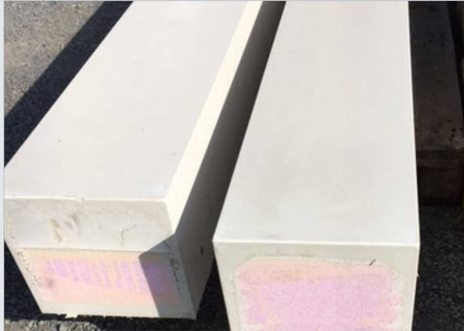
Pfeiler mit Faserbeton-ummanteiletem EPS-Kern
